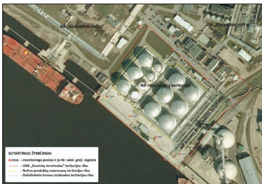
2.10.1 pav. Požeminio vandens monitoringo gręžiniai UAB „Krovinių terminalas“ teritorijoje (UAB „GEOTECH Baltic, 2015).
